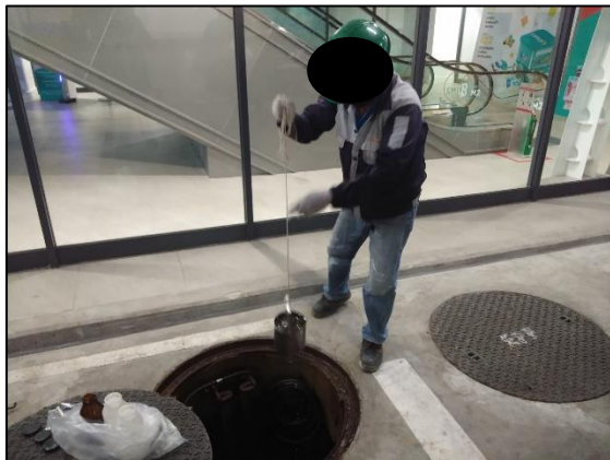
บ่อกักสุดท้ายก่อนระบายออกสู่ท่อระบายน้ำสาธารณะ
